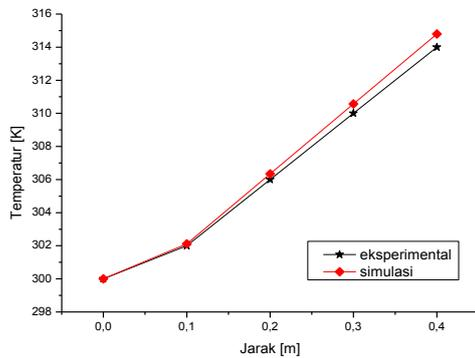
**Gambar 18.** Hubungan antara temperatur fluida terhadap jarak atau ketinggian dari batang silinder untuk melihat perbedaan dari pengujian eksperimental dengan simulasi dengan fluks panas  $500000 \text{ W/m}^2$  pada kecepatan aliran fluida  $0,3 \text{ m/s}$ .
