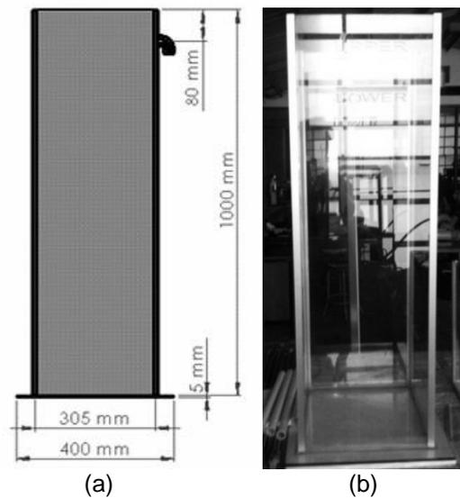
**Gambar 3.** seksi uji (a). Desain (b). bentuk fisik
