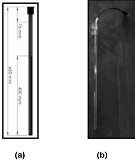
**Gambar 12.** Silinder pemanas, (a). Desain (b). Bentuk fisik
