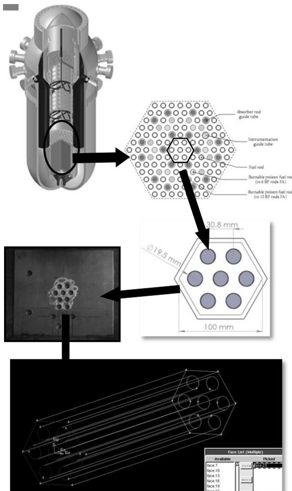
**Gambar 2.** Pemodelan Alat Uji
