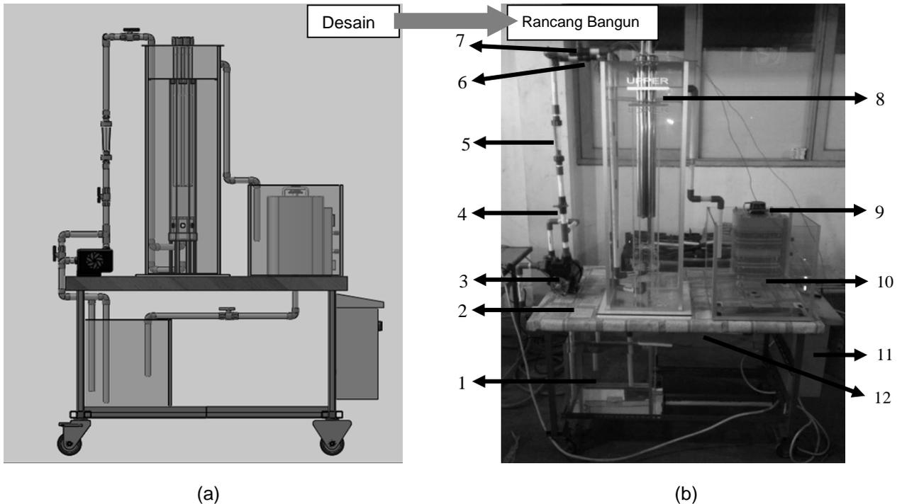
**Gambar 17.** (a). Desain model alat uji. (b). Bentuk fisik model alat uji
