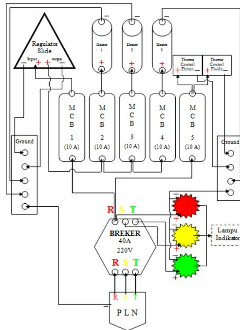
Gambar 16. Skema instalasi listrik
