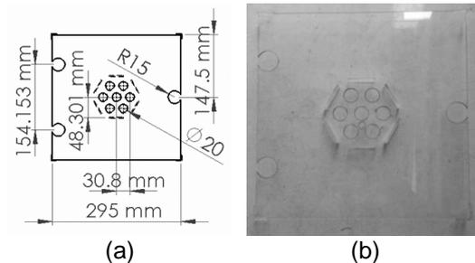
**Gambar 11.** *Spacer* atas, (a).Desain, (b).bentuk fisik
